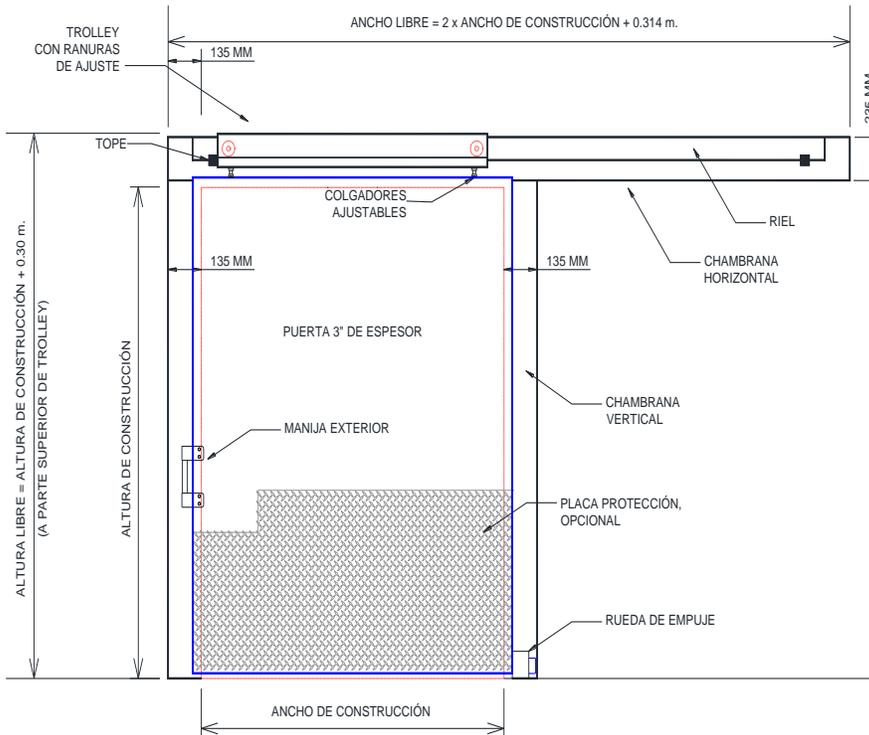
SE REQUIERE 0.30 M. SOBRE LA ALTIMA DE CONSTRUCCIÓN PARA ALOJAR CHAMBRANA HORIZONTAL Y RIEL; PARA LA AUTOMATIZACIÓN (MOTORIZACIÓN) REQUIERE UNA ALTIMA DE 1.0 MT. SOBRE LA ALTIMA DE CONSTRUCCIÓN.
